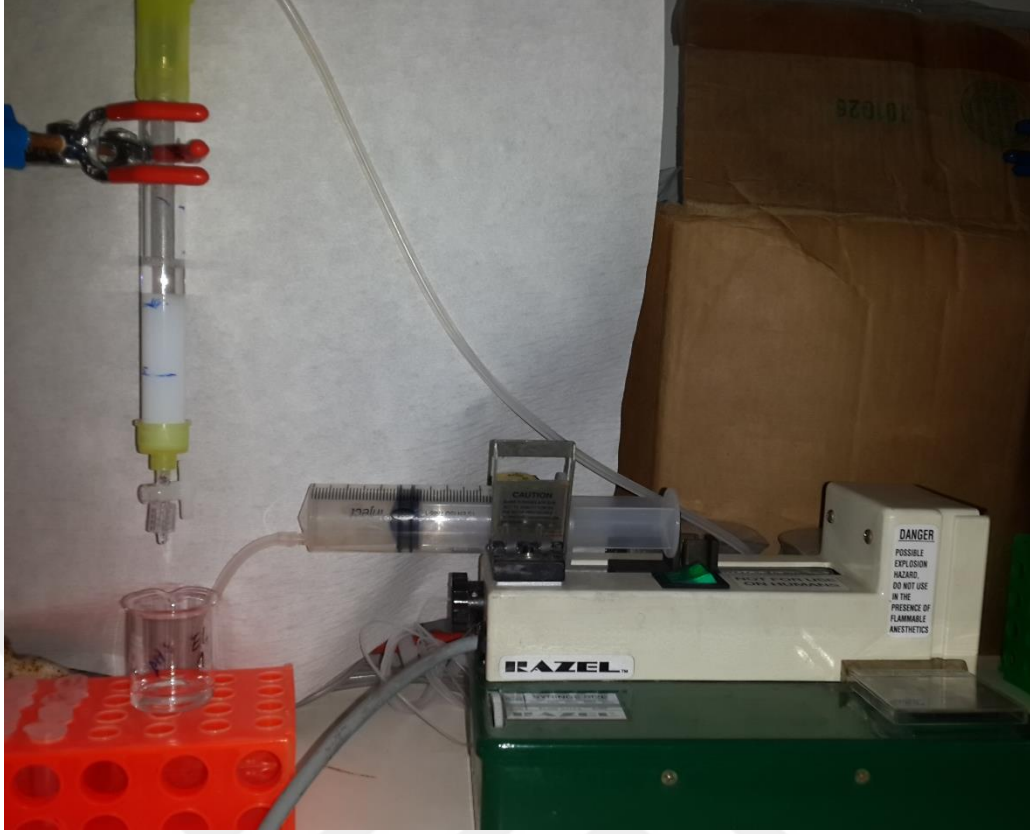
Şekil 3. 12 DEAE kolonuna yüklenen örnekten şırınga pompası ile 6ml/saat hızında gp63'ün saflaştırılması
