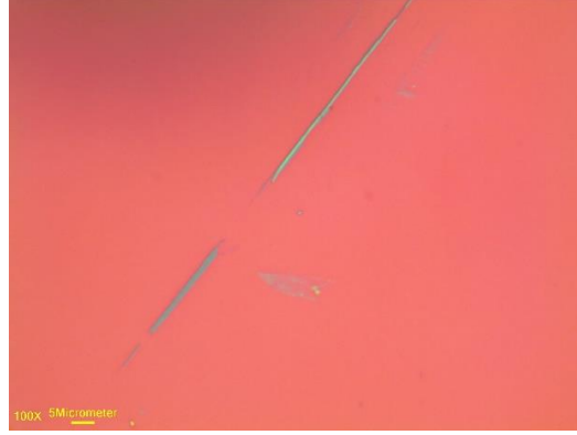
Şekil 3.4. Mikromekaniksel yöntemle sentezlenen \text{TiS}_3 tabakalarının optik mikroskop görüntüsü
