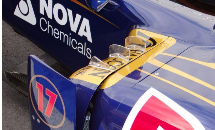
Şekil 3.34: F1 Aracında Sidepod Girişindeki Vorteks Jeneratörü [33].
