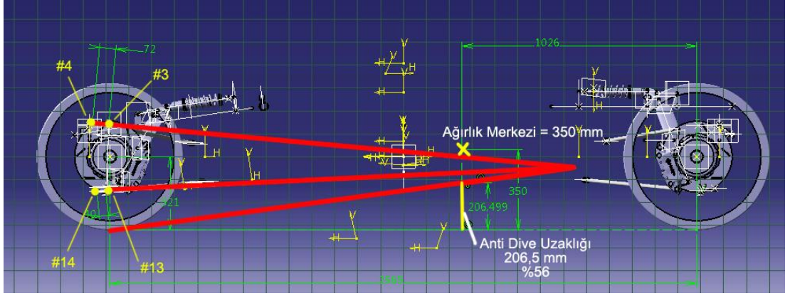
Şekil 4.16: Ön Süspansiyonun Yandan Ayarlanması.
