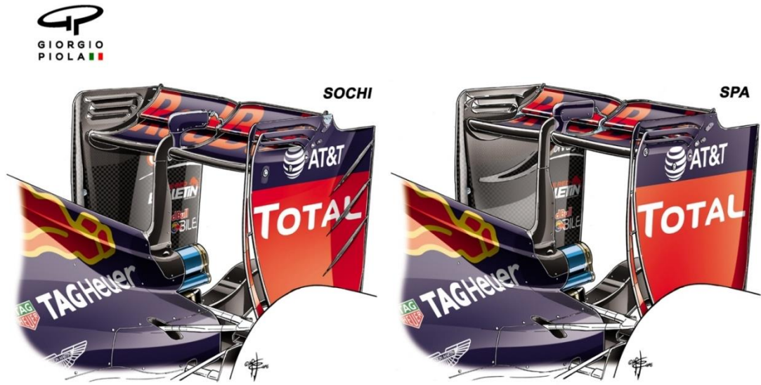
Şekil 3.36: Farklı Pistler İçin Geliştirilen Kanat Profilleri [34].
