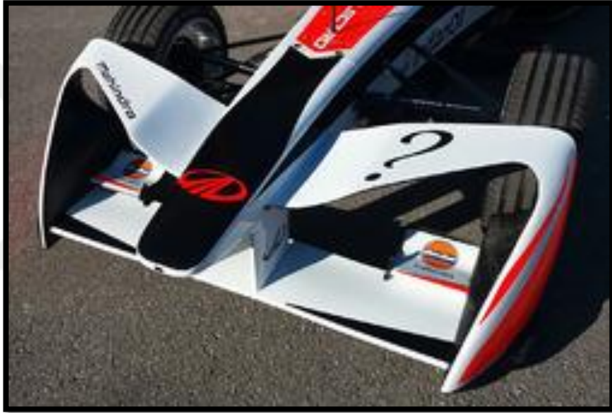
Şekil 5.12: Formula E Mahindra Takımının Ön Kanadı [42].
