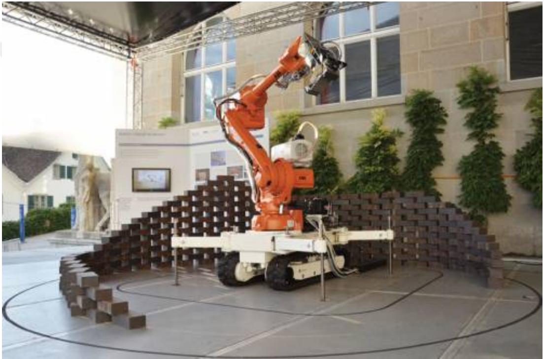
Şekil 2.6 : ETH Zürich dFab ekibinin geliştirdiği “dimRob”.
