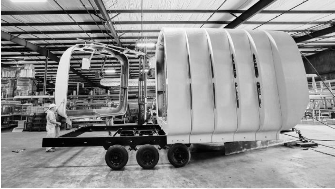
Şekil 4.5 : Pavilyon projesinin prekast modüllerinin bir araya getirilişi.
