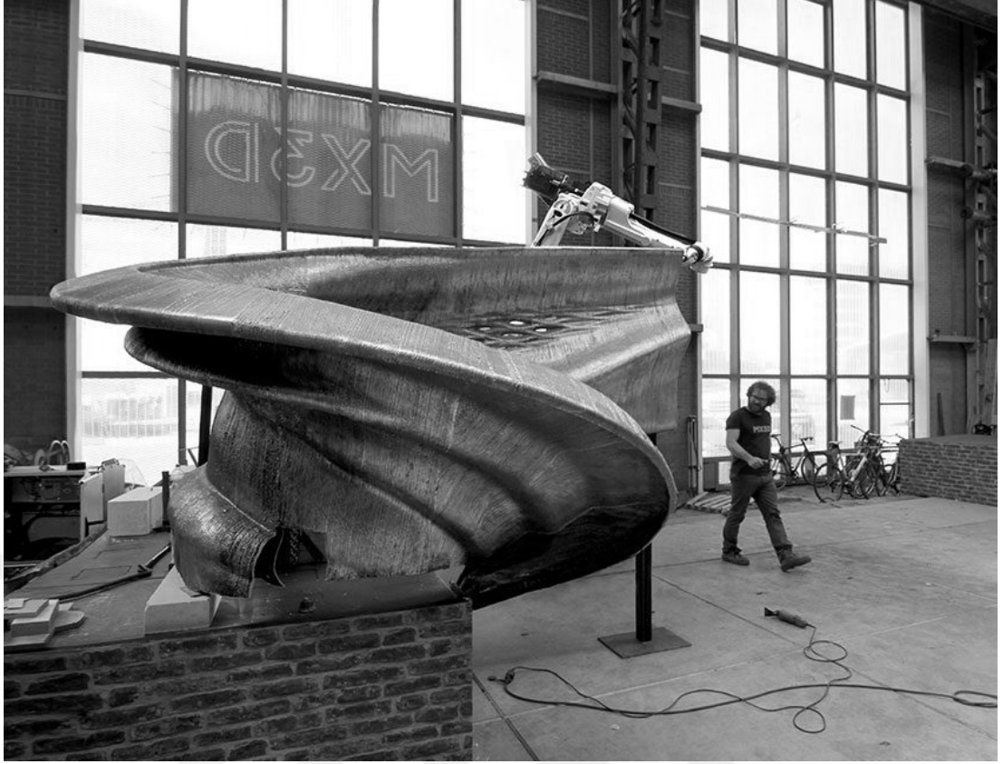
Şekil 4.4 : Robot kolla 3B Baskı yöntemi ile yapılan köprü projesi imalat test aşaması.
