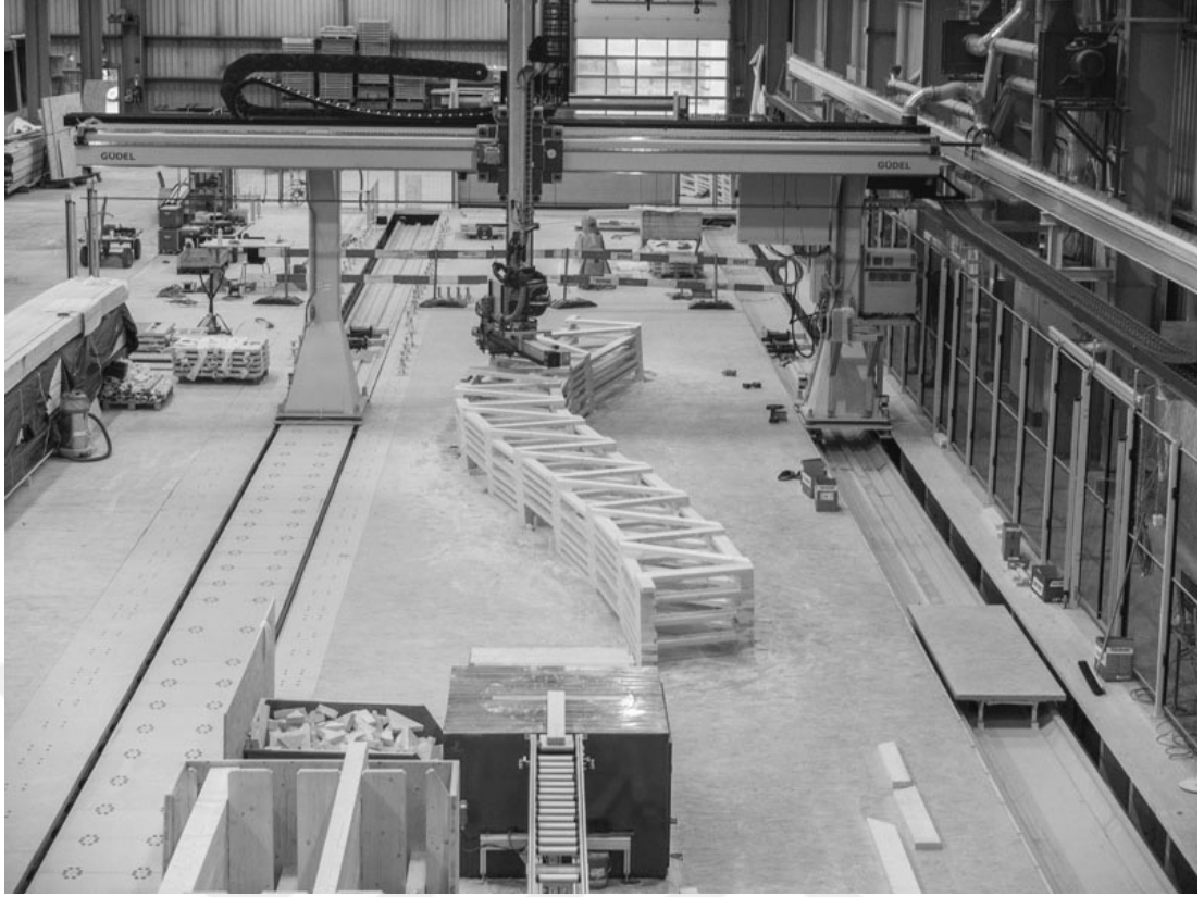
Şekil 4.15 : 7 akslı robot yardımıyla üretilen kirişler.
