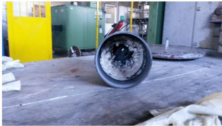
Şekil 6.5 : Deneyler sonrasında elde edilen taç magnezyum.
