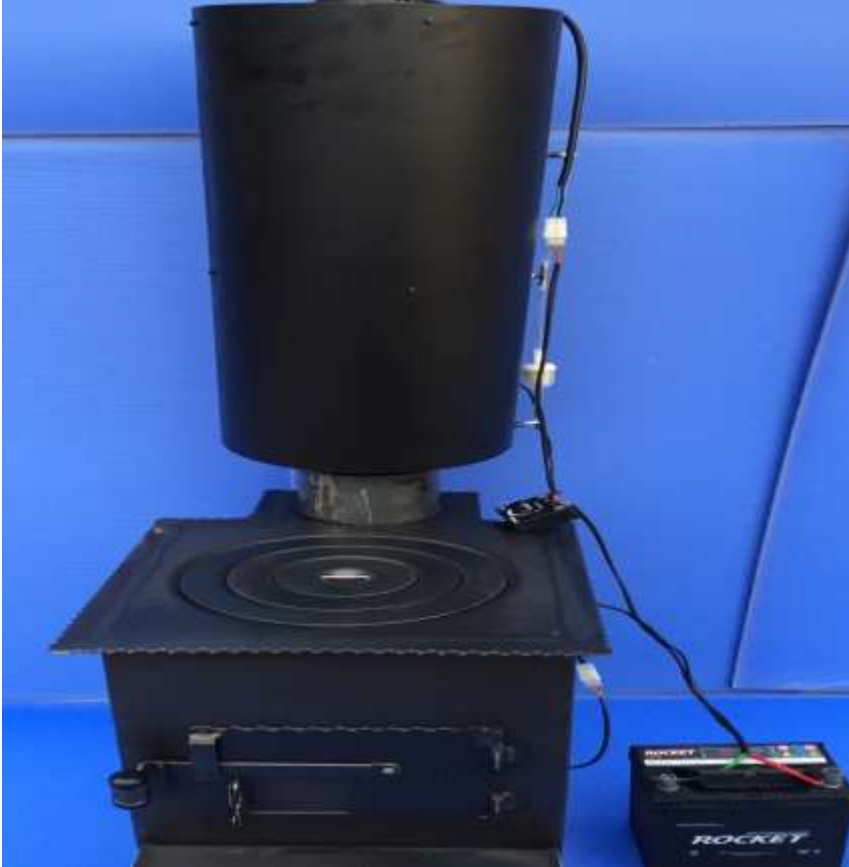
Şekil 22. Baca çıkışına kontrol cihazının monte edilmesi
