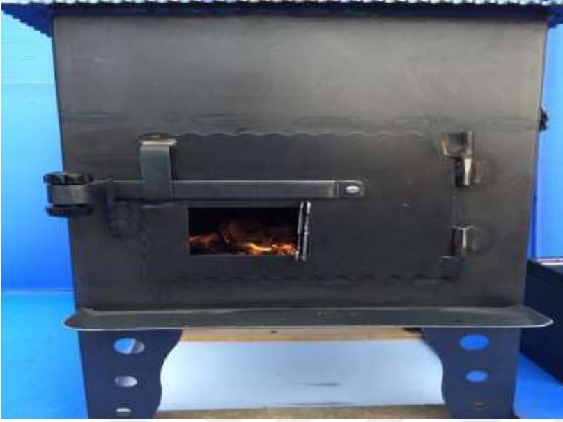
Şekil 21. Kömürün sobanın yanma bölümüne konulması ve tutuşturulması
