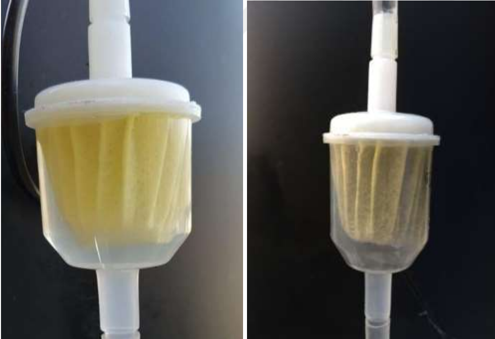
Şekil 35. Su filtresi çalışma öncesi ve sonrası karşılaştırılması
