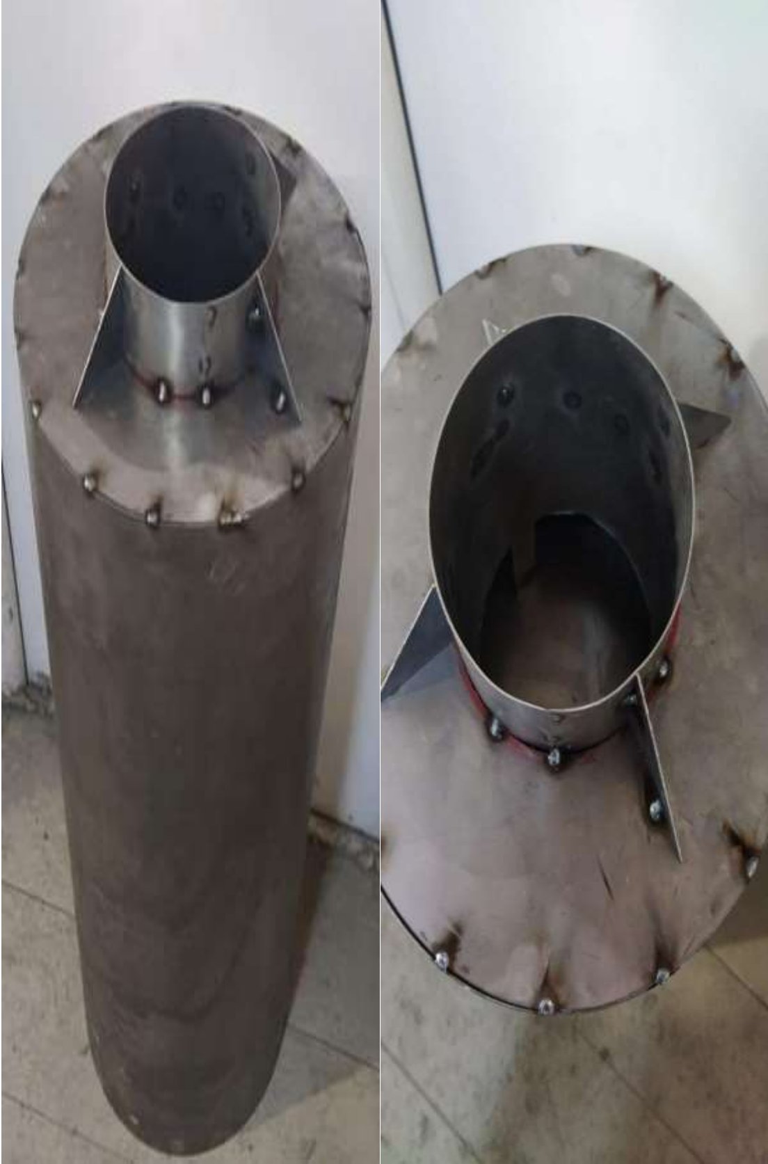
Şekil 15. Dış gövde, üst gövde, baca borusu bağlantı parçası ve ara plakanın punta kaynağı ile birleşimi
