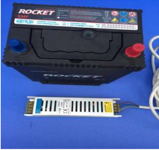
Şekil 28. 220-12 volt düşürücü adaptör ve 12 volt 30 amper akü
