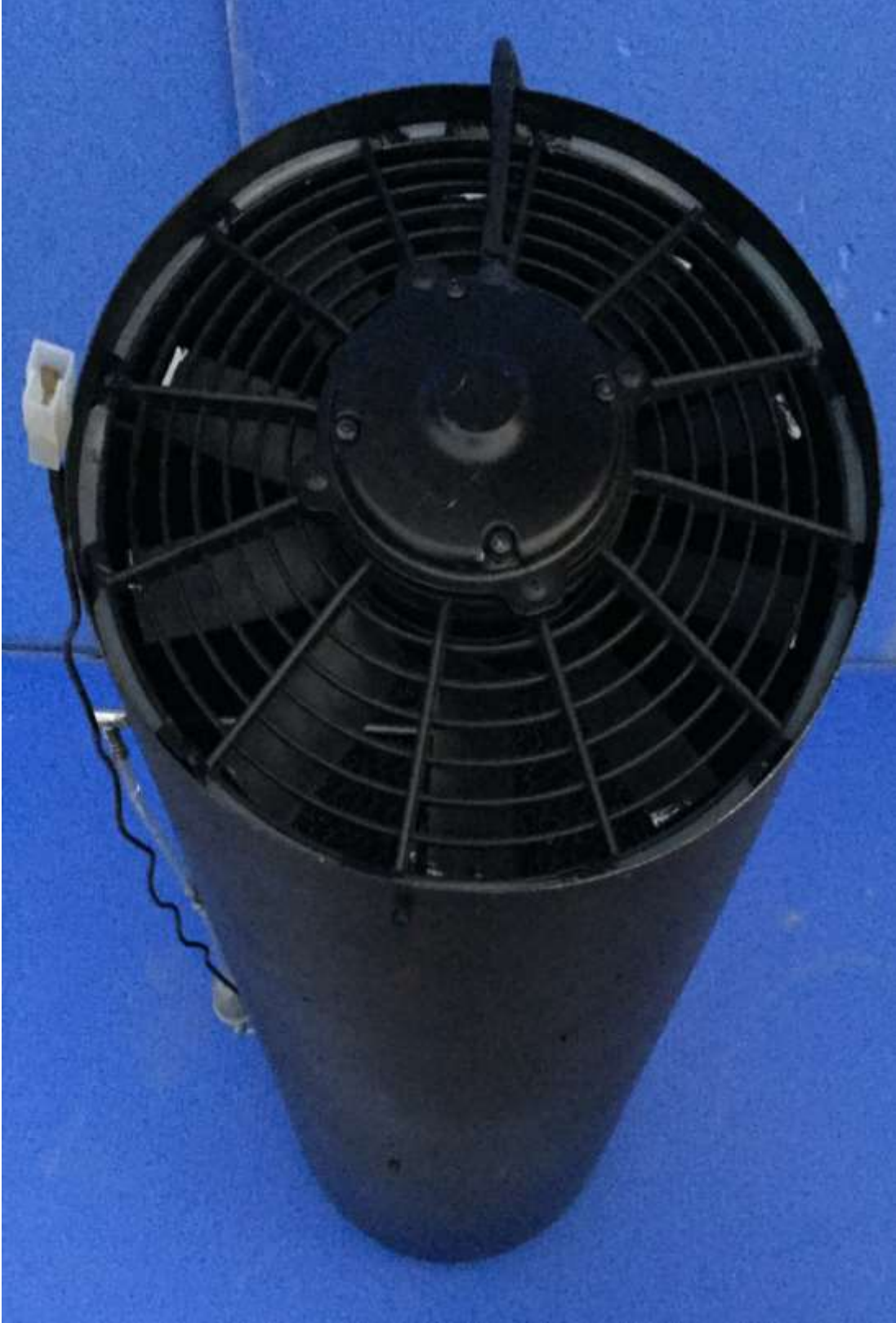
Şekil 19. Aksiyel fan ve konumu
