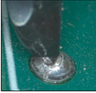
Şekil 2.35. Mekanik şok altında lehim kırılması [71]
