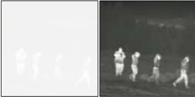
Şekil 2.19. Sisli termal kamera görüntüsüne etkisi [40]
