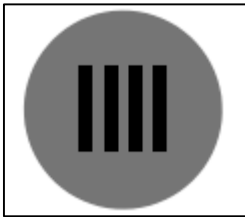
Şekil 2.15. MRTD ölçümleri için kullanılan standard periyodik dört çubuk hedefi [26]
