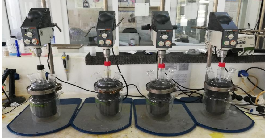
Şekil 3.13. 1L hacimde uygulanan liç işlemi
