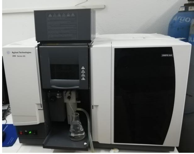
Şekil 3.3. Agilent 240 AAS cihazı
