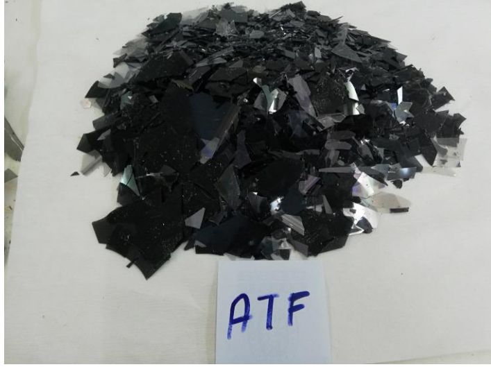
Şekil 3.9. Alkol ve aseton yardımıyla polarize filmde ayrılan LCD numune
