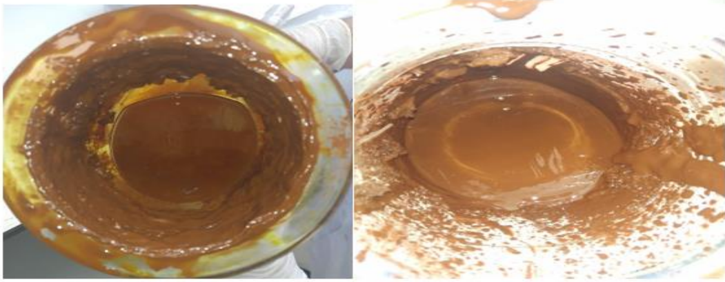
Şekil 4.11 500 rpm karıştırmada 8M H 2 SO 4 ve 8M HCl asitlerin deney sonu görüntüsü
