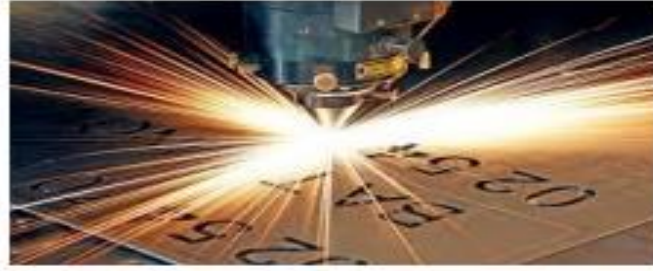
Şekil 1.7. Neodimyum Kullanıldığı Lazer kesme sistemi [24]
