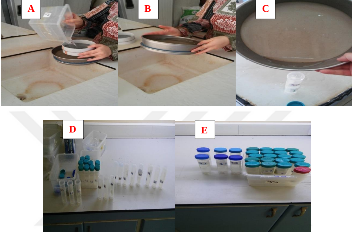
Şekil 3.6. Baermann Huni Yöntemiyle hazırlanan düzenekten nematod solüsyonu elde edilmesi A, B: Plastik kaptaki nematodlu solüsyonun elekde (25 \mu mesh) süzülmesi, C: Nematodların elekten falcon tüplerine aktarılması, D, E: Nematodlu solüsyon içeren Falcon tüpleri
