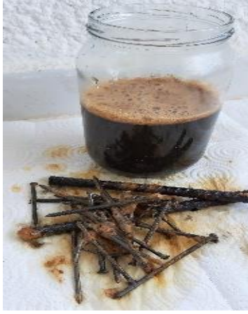
Resim 3.8. (solda) Demir çözeltilisinin hazırlanması
