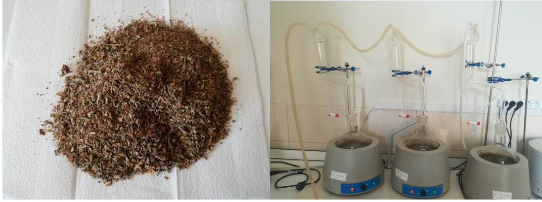
Şekil 3.8. Öğütülmüş örnek ve Clevenger cihazı ile uçucu yağ eldesi
