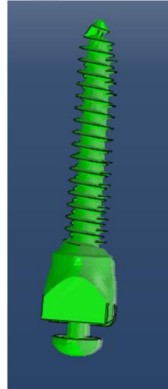
Şekil 47. Kortikal kemik içerisindeki vidalarda oluşan hareketin sagittal kesitten görüntüsü.
