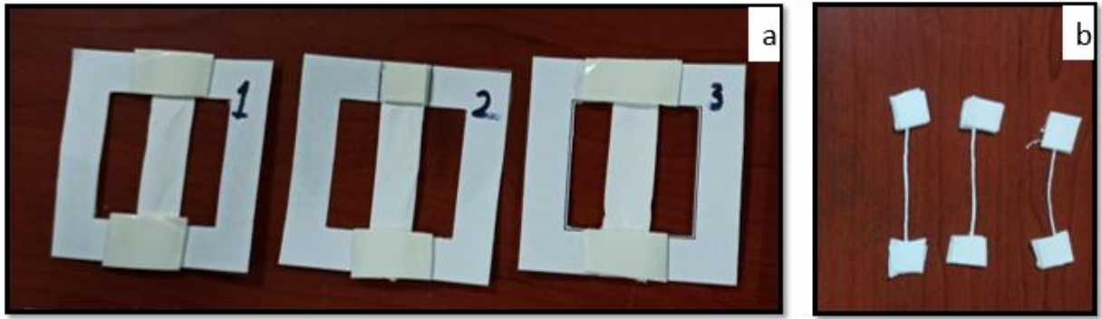
Şekil 3.10. Çekme testi için hazırlanan numuneler a)Nanofiber mat b)Nanofiber suture
