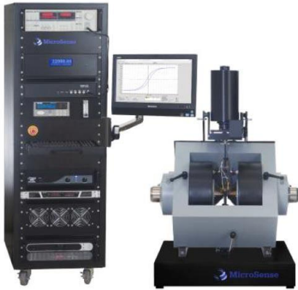
Şekil 3.13. MicroSence marka VSM - Titreşimli Numune Manyetometresi (“VSM”, 2021)
