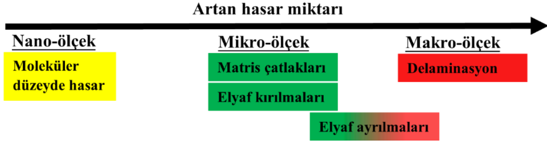
Şekil 2.12: Boyutlarına göre kompozit malzeme içerisinde oluşan hasar tipleri.
