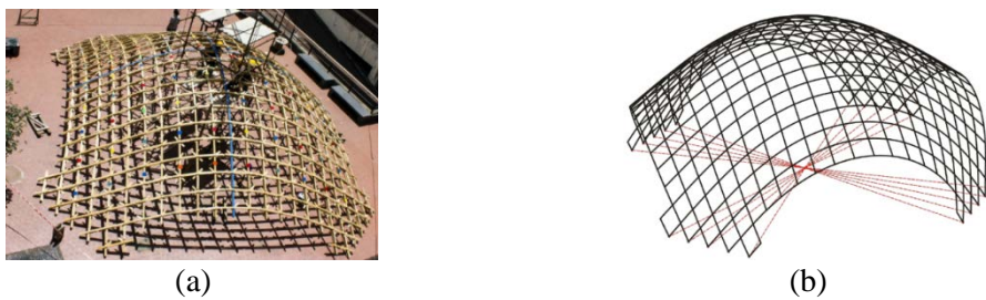
Resim 3.17. (a) Uygulanan yapı, (b) Bir merkez etrafında oluşturulan simetrik model (D'Amico ve diğerleri, 2015)
