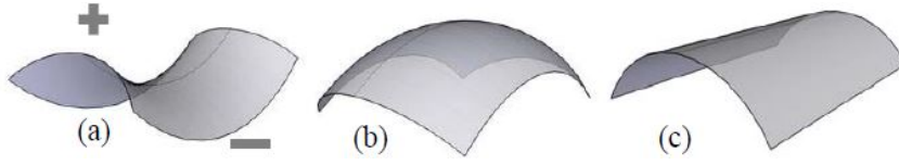
Şekil 3.8. (a) Negatif, (b) Pozitif ve (c) Sıfır Gauss eğriliği yüzeyleri (Toussaint, 2007)
