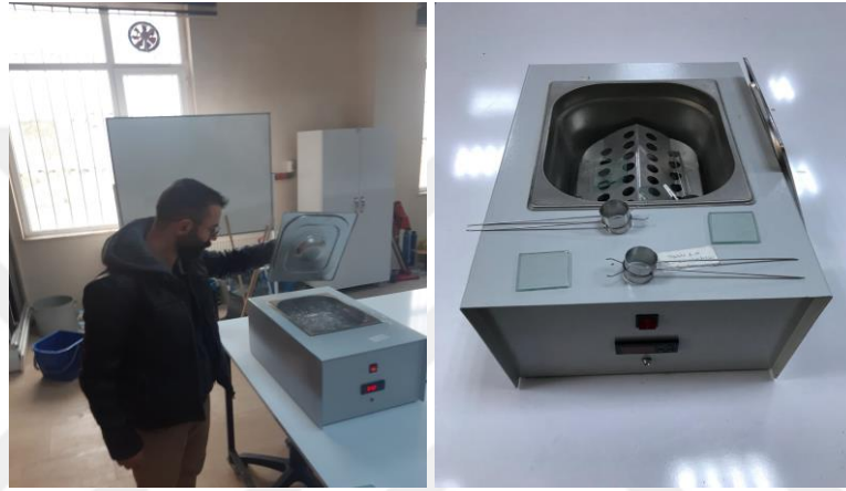
Resim 3.11. Le Chatelier cihazı ile genleşme deneyi
