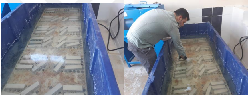
Resim 3.7. Kür havuzunda bekletilen numunelerimiz
