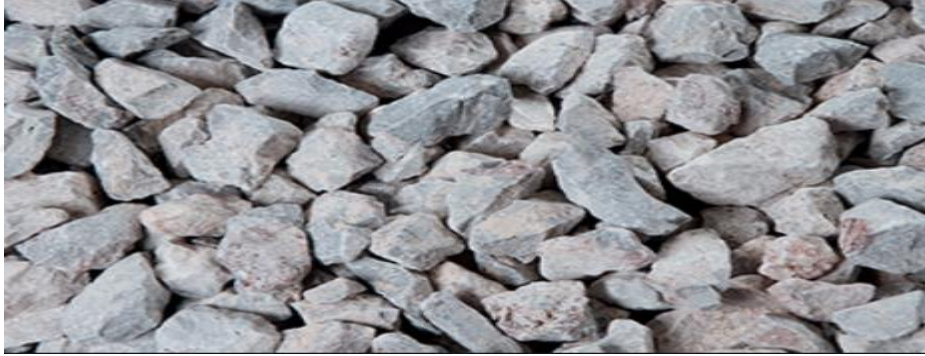
Resim 2.4. Agrega olarak kullanılan havada soğutulmuş cürufun görüntüsü (Ulugöl ve diğerleri, 2015)
