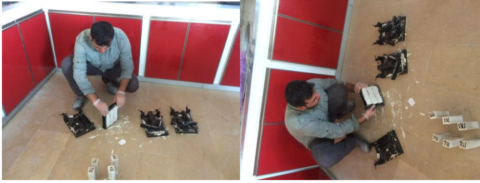
Resim 3.6. Numunelerin Kalıptan Sökülmesi
