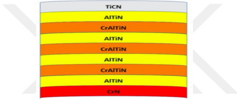
Şekil 4.1 : Toz metalurjisi ile üretilen Vanadis 10 kalite takım çeliğinin kaplama tabakasındaki katmanların şematik gösterimi [40].
