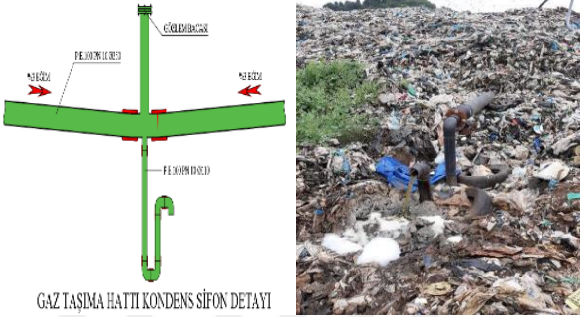
Şekil 70. Gaz taşıma hattı kondens sifonu (TRAB-Rİ KAB)
