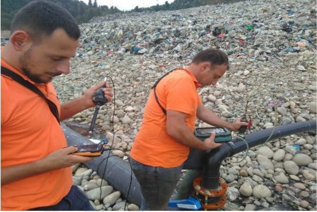
Şekil 69. Mevcut depolama sahasında gaz ölçümü (TRAB-Rİ KAB)
