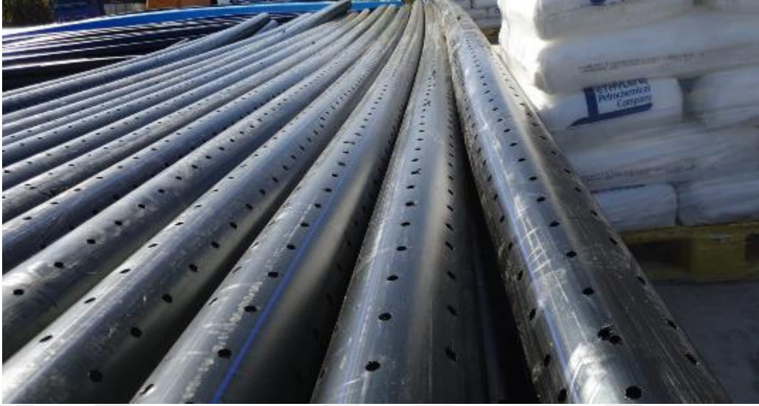
Şekil 40. Delikli gaz toplama borusu (TRAB-Rİ KAB)
