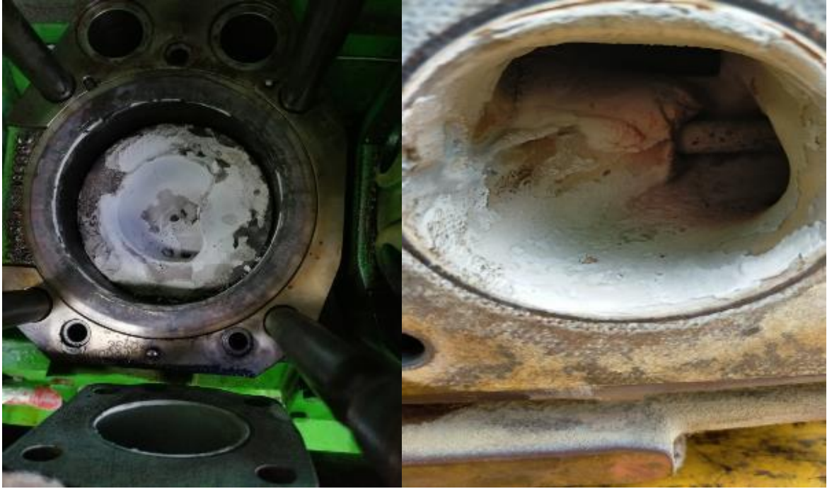
Şekil 77. Hidrojen sülfürün parçalanarak kükürte dönüşmesi sonucu motorlara verdiği zarar görüntüleri (TRAB-Rİ KAB)
