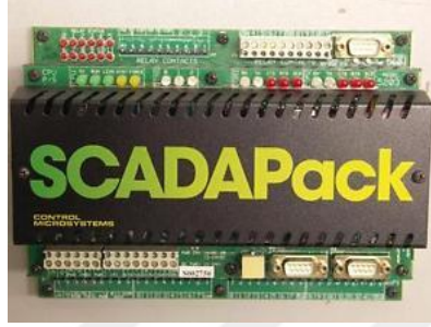
Şekil 3.10: Örnek bir SCADA RTU (SE, 2020).
