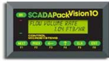
Şekil 3.11: Örnek bir HMI arayüzü (SE, 2020).
