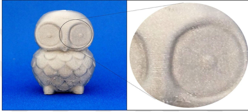
Şekil 1.7 3 Boyutlu Baskı Sonrası Model Üzerindeki Katman Çizgileri
