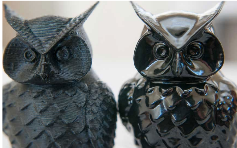
Şekil 1.8 Baskı Sonrası Orijinal Model – Kimyasal Solvent Uygulanmış Model
