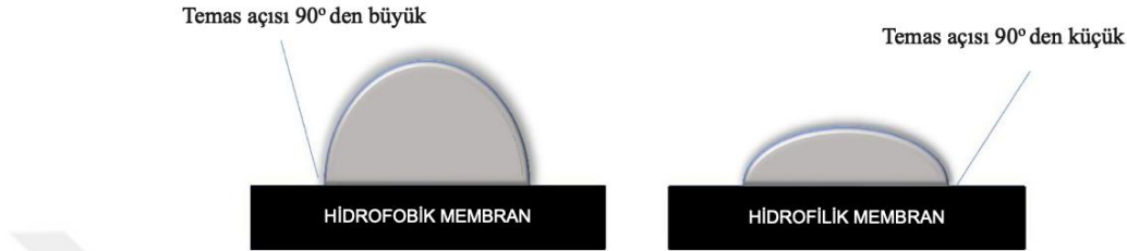
Şekil 9. Hidrofobik ve hidrofilik yüzeylerin temas açısı ölçümleri [65].
