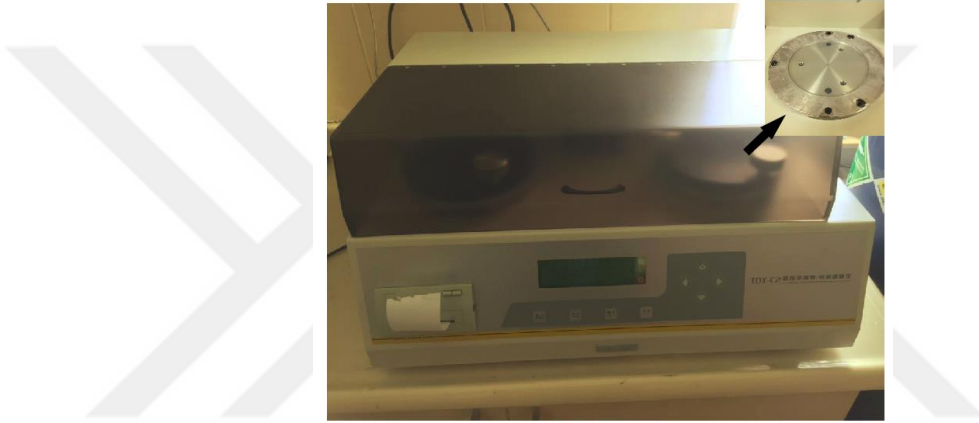
Şekil 20. LabThink TOY C2 Oxygen Permeability Tester oksijen geçirgenlik test cihazı.
