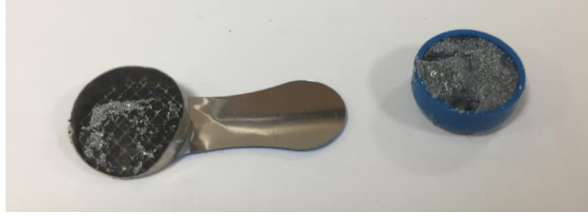
Şekil 23. Pilin metal kılıftan ayrılması
