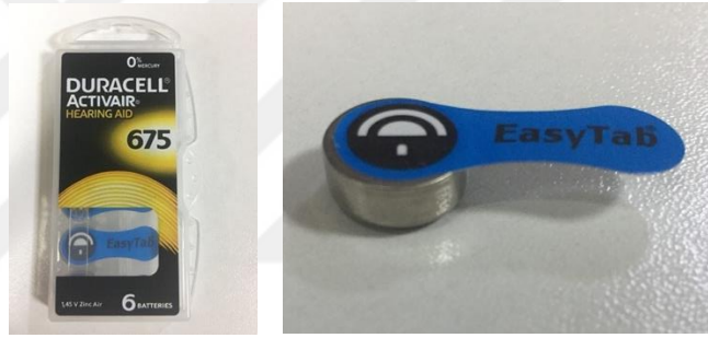
Şekil 14. Deneylerde kullanılan duracell activair 675 boyutundaki çinko hava pili.
