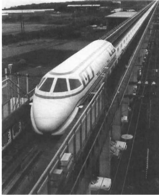
Şekil 2.1: Japonya'nın geliştirdiği 500 km/saat üzerinde hıza ulaşan süperiletken Mag-Lev sistemi [36].
