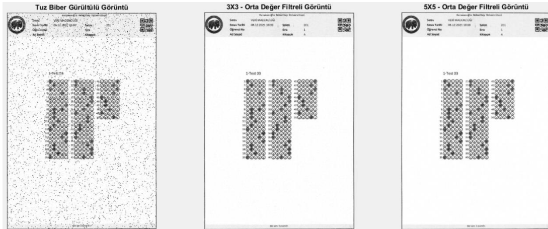
Şekil 3.13: Orta değer filtresi kullanılmış görüntüler.
