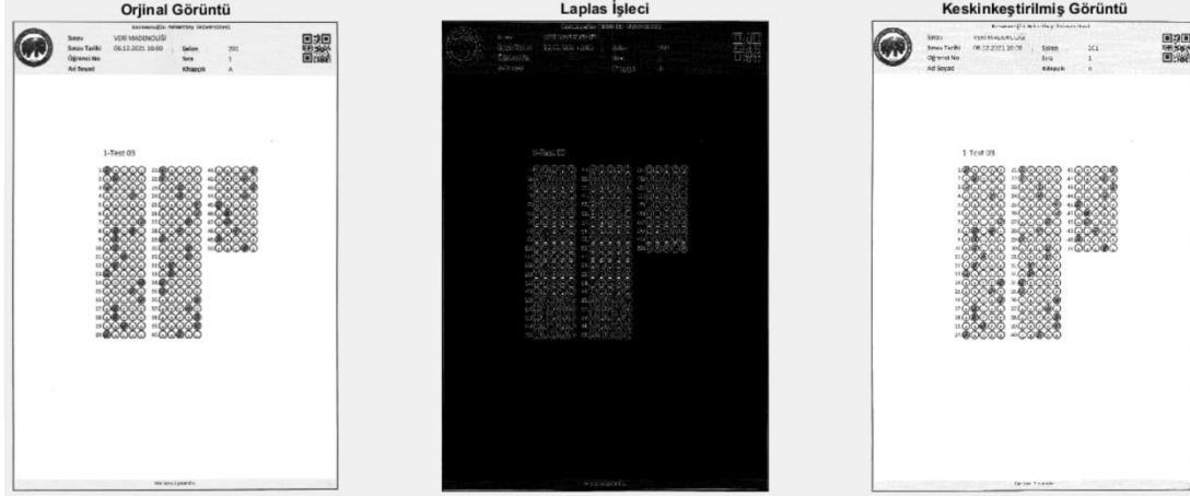
Şekil 3.9: Orijinal ve keskinleştirilmiş görüntü.
