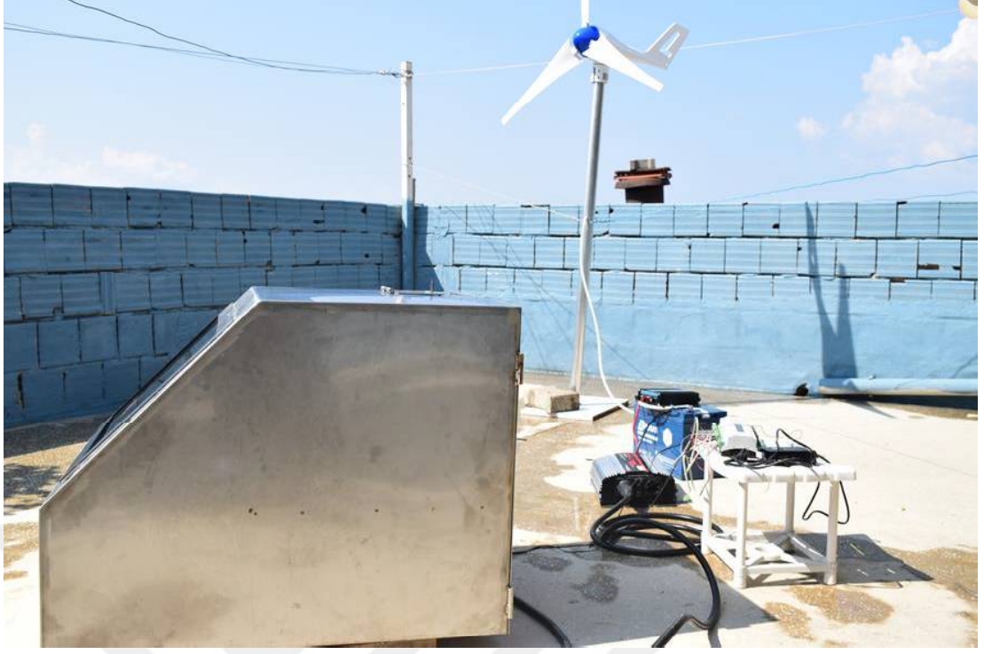
Şekil 4.2b. Güneş ve rüzgar enerjisi destekli kurutma sistemi montaj resmi (yandan görünüş)
