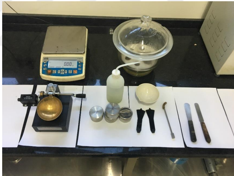
Cassagrande aletindeki birleşmiş örnekten palet bıçağı yardımıyla yaklaşık 30g örnek alınarak kapaklı metal kap içine konulmuş ve etüvde kurutma metoduyla nem içeriği (w) ölçülmüştür.
