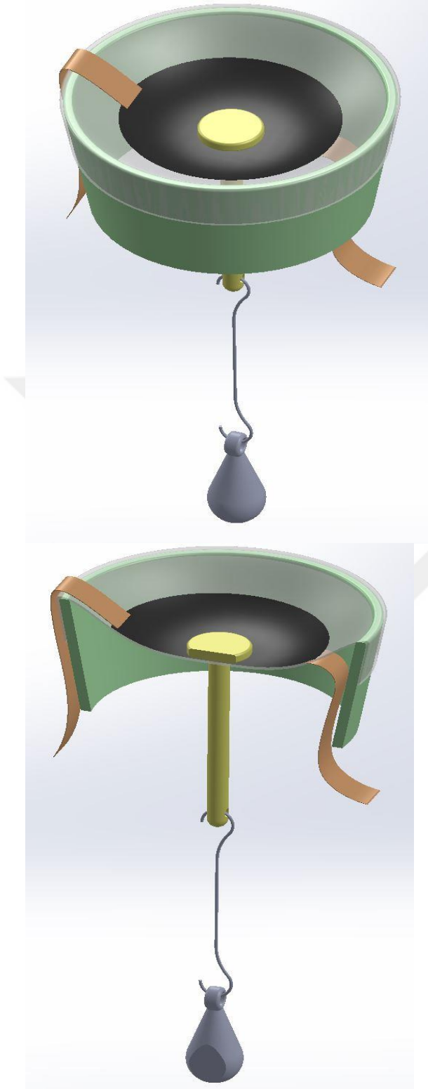
Şekil 3.11. Dairesel bir DEA’ya gerilim uygulandığında meydana gelen değişim.
