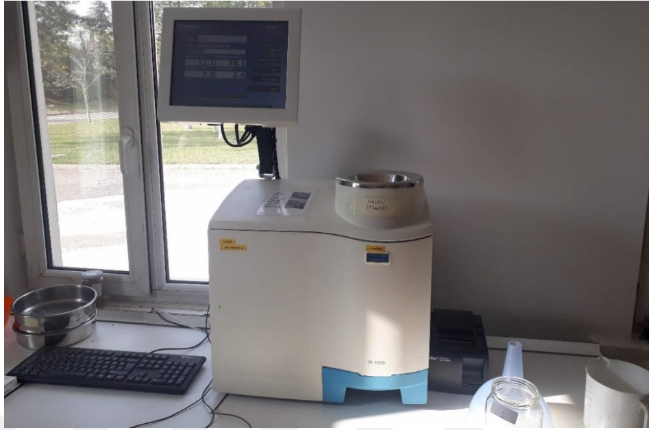
Şekil 4.30. NIT cihazı ile hektolitre, nem, yağ ve protein tayini yapılması
