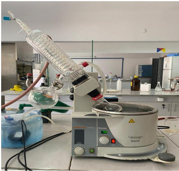
Şekil 3.5. Fazla çözücünün evaporatör ile buharlaştırılması Şekil 3.6. Sıvı-sıvı ekstraksiyon
