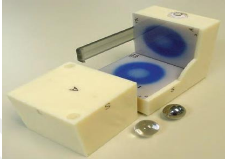
Şekil 20: AQA Ballcube Fantomu (Akbayırılı 2017)
