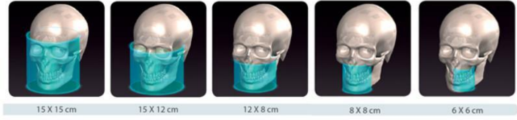
Şekil 4. Tarama yapılacak görüntüleme alanının (FOV), yükseklik ve genişliğinin ayarlanabilmesi (Ergün ve Güneri, 2019)
