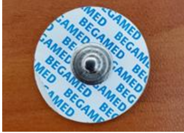
Şekil 3.1. Sinyali elde etmek için kullanılmış elektrotlar
