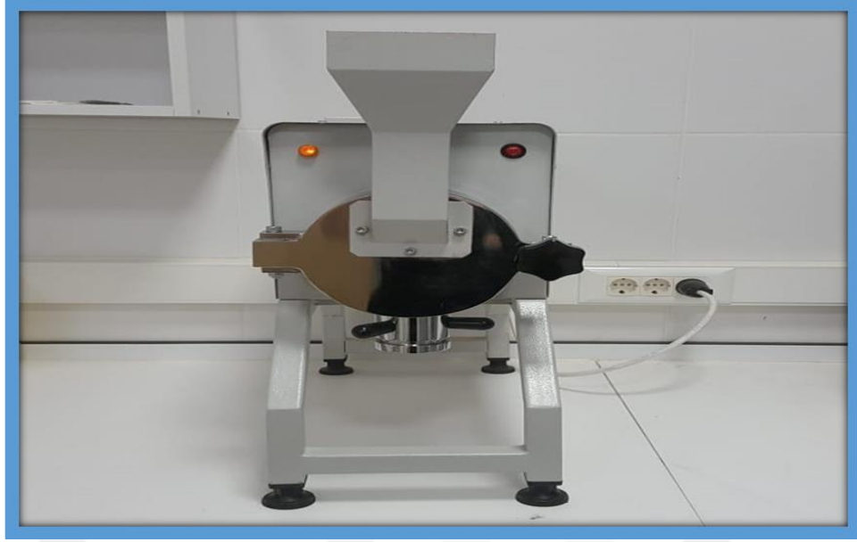
Şekil 4.3: Bitki liflerinin öğütülmesinde kullanılan öğütücü
