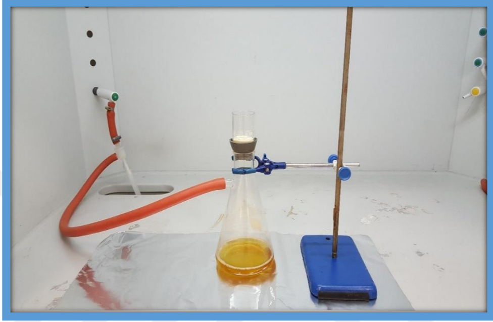
Şekil 4.9: Klorlama işleminden sonra gerçekleştirilen süzme işleminin deney düzeneği
