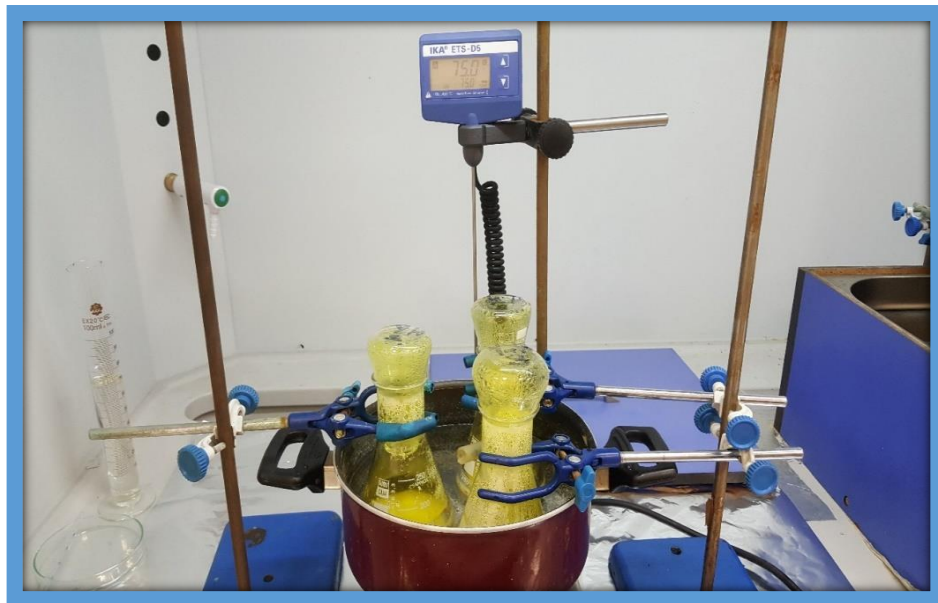
Şekil 4.8: Holoselüloz tayininin gerçekleştirildiği deney düzeneği
