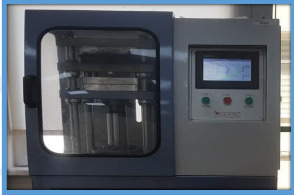
Şekil 4.13: Plaka üretiminde kullanılan sıcak pres cihazı
