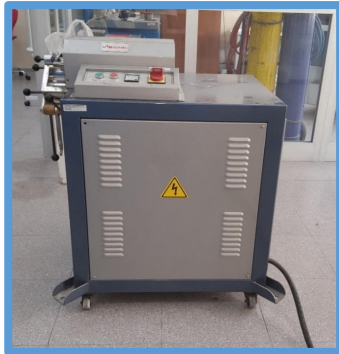
Şekil 4.12: Yüksek hızlı termokinetik karıştırıcı (gelimat) cihazı
