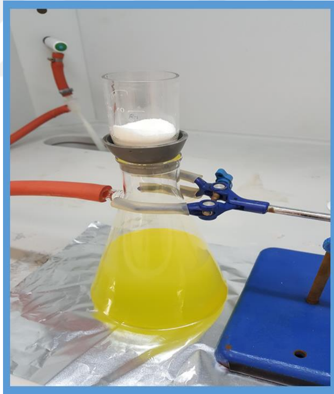
Şekil 4.11: Örneklerin alfa selüloz tayini sonrası yapılan süzme işlemi
