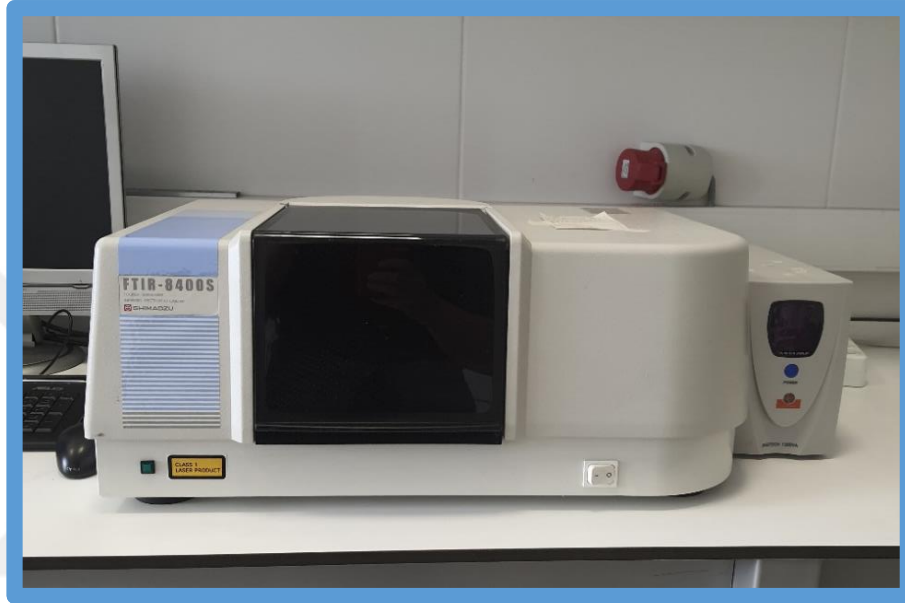
Şekil 4.17: FTIR analizlerinin yapıldığı Shimadzu FTIR 8400s cihazı
