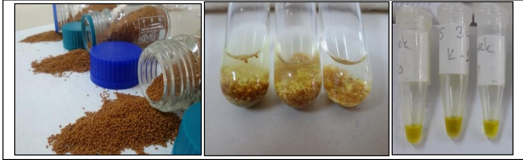
Şekil 3.5. Ketencik tohumlarından n-hekzan ile soğuk ekstraksiyon yapılarak ham yağ eldesi
