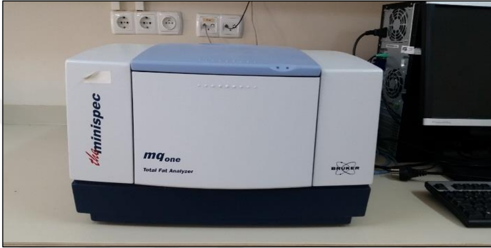
Şekil 3.4. Ketencik tohumunda yağ oranının belirlendiği NMR cihazı
