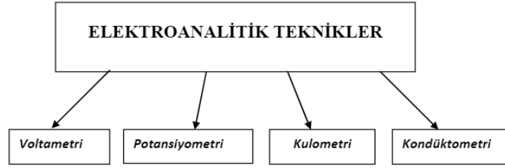
Şekil 2.3 Temel elektroanalitik tekniklerin şematik gösterimi ve en genel sınıflandırılması (Anonim)
