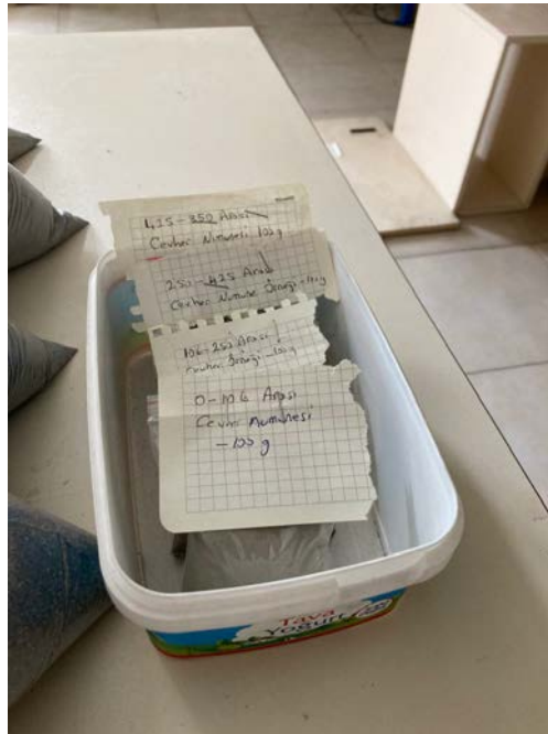
Şekil 3.3. XRF analizi için tane boyutlarına göre ayrılmış elek numuneleri.
