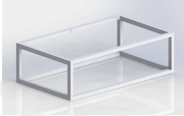
Şekil 3.7. Bariyersiz sallantılı masa şasesi katı model görünümü.
