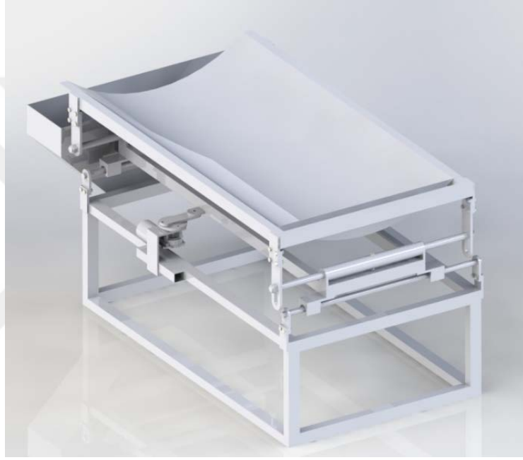
Şekil 3.11. Bariyersiz sallantılı masa katı model çizimi.
