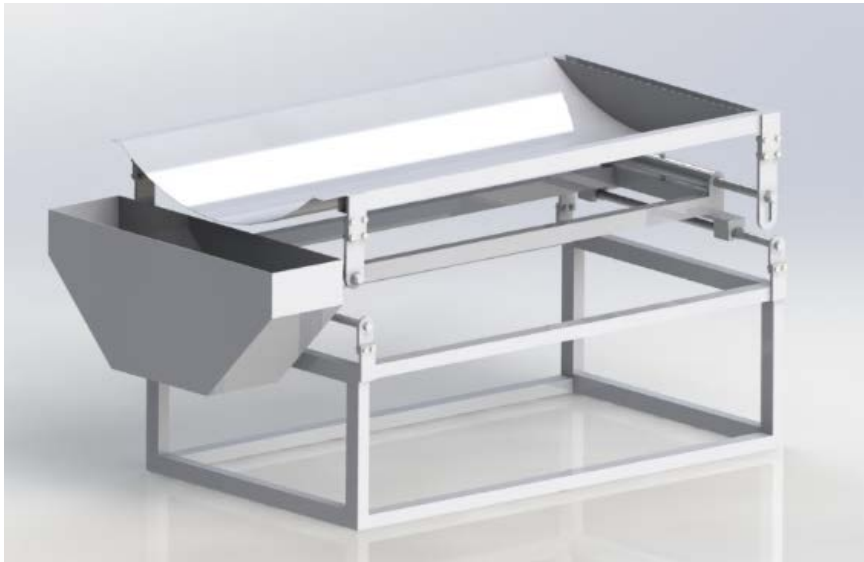
Şekil 3.10. Cevher ayırıştırma tablası ve atık havuzu katı model görünümü.
