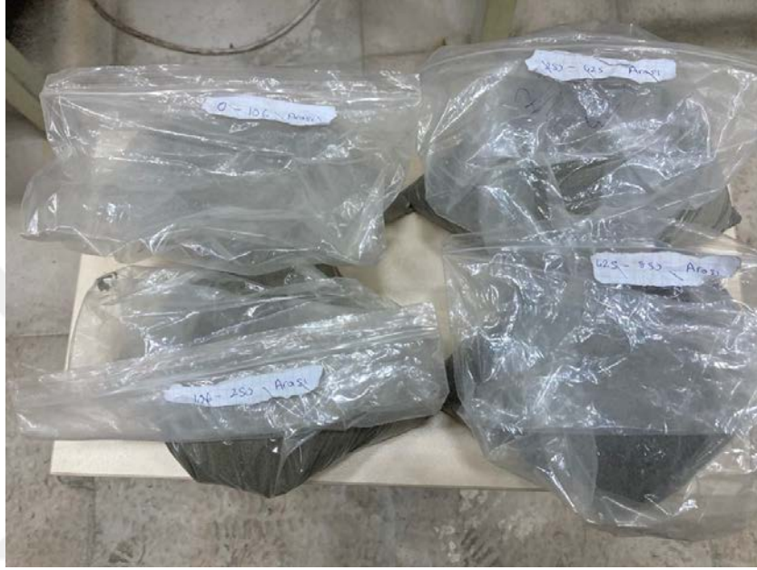
Şekil 3.2. Eleklerden tane boyutlarına göre ayrılmış elek numuneleri.
