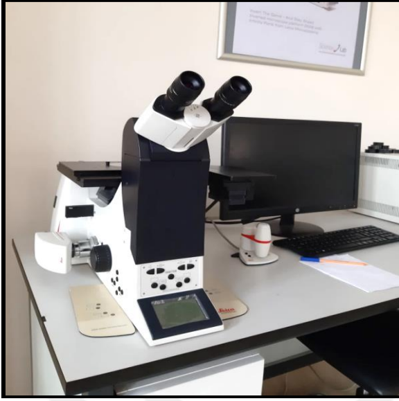
Resim 5.5. Leica DMI5000 M yazılımı ile ters çevrilmiş araştırma mikroskobu
