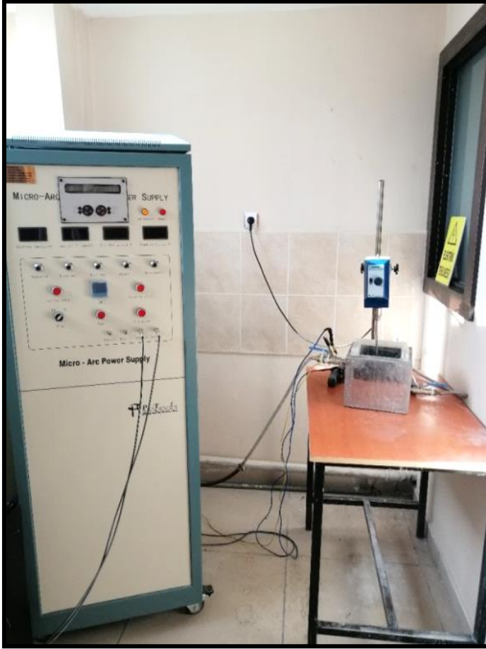
Resim 5.1. Kaplama işlemin de kullanılan MAO cihazı
