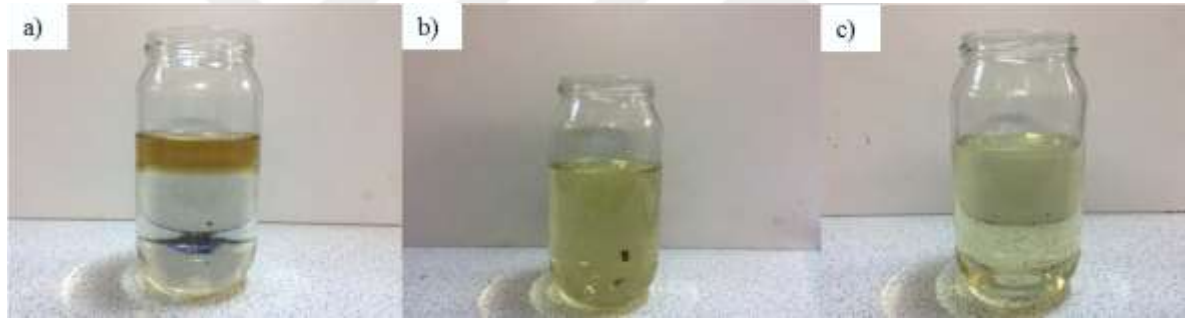
Şekil 9. Epoksi reçine sistemi (a) Karıştırmadan önce (b) Mekanik karıştırmadan sonra (c) 45 dakika gaz giderme işleminden sonra
