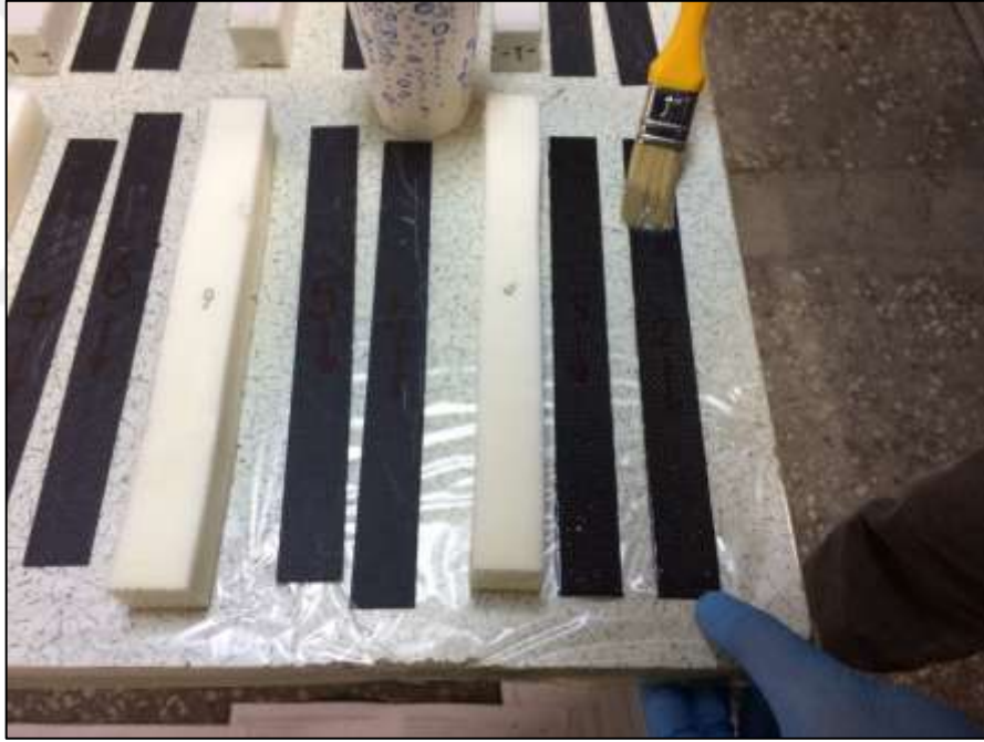
Şekil 20. Yüzey tabakalarına ara yüzey yapıştırma işlemi
