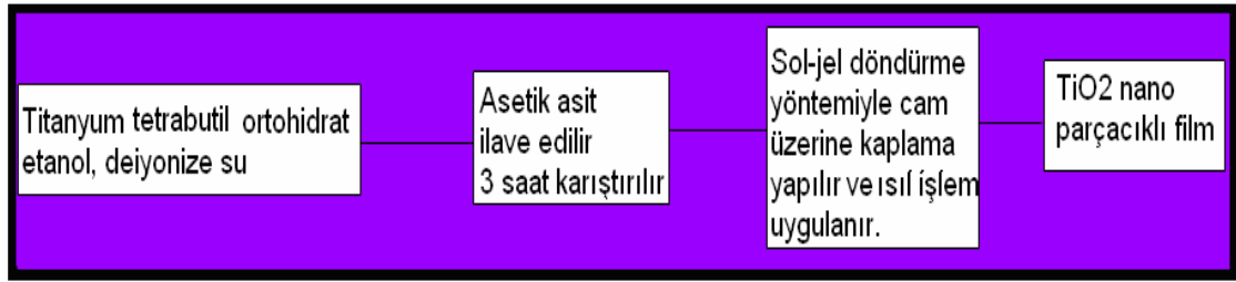
Şekil 8.1: Nano parçacıklı TiO 2 filmin hazırlanması diyagramı.
