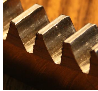
Şekil 4. 100 Nm burulma momenti ile yüklenen, motor hızı 1500 d/d, yüzey kaplaması bulunmayan çember dişli çarkın makro fotoğraf çekimleri
