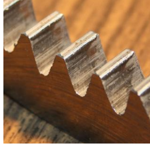
Şekil 4. 100 Nm burulma momenti ile yüklenen, motor hızı 1500 d/d, yüzey kaplaması bulunmayan çember dişli çarkın makro fotoğraf çekimleri
