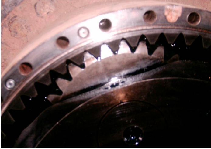
Resim 2.2. İş makinasının paletinde bulunan planet dişli sistemi
