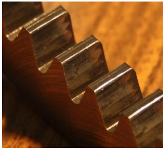
Şekil 4. 100 Nm burulma momenti ile yüklenen, motor hızı 1500 d/d, yüzey kaplaması bulunmayan çember dişli çarkın makro fotoğraf çekimleri
