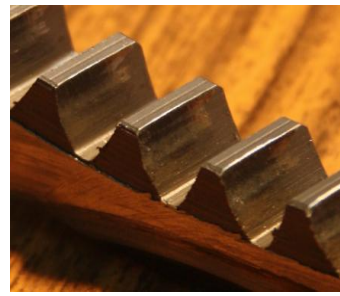
Şekil 4. 100 Nm burulma momenti ile yüklenen, motor hızı 1500 d/d, yüzey kaplaması bulunmayan çember dişli çarkın makro fotoğraf çekimleri
