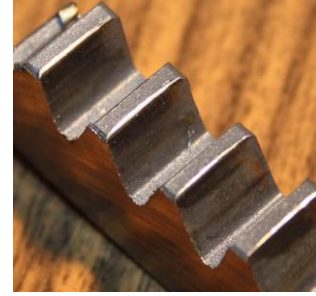
Şekil 4. 100 Nm burulma momenti ile yüklenen, motor hızı 1500 d/d, yüzey kaplaması bulunmayan çember dişli çarkın makro fotoğraf çekimleri
