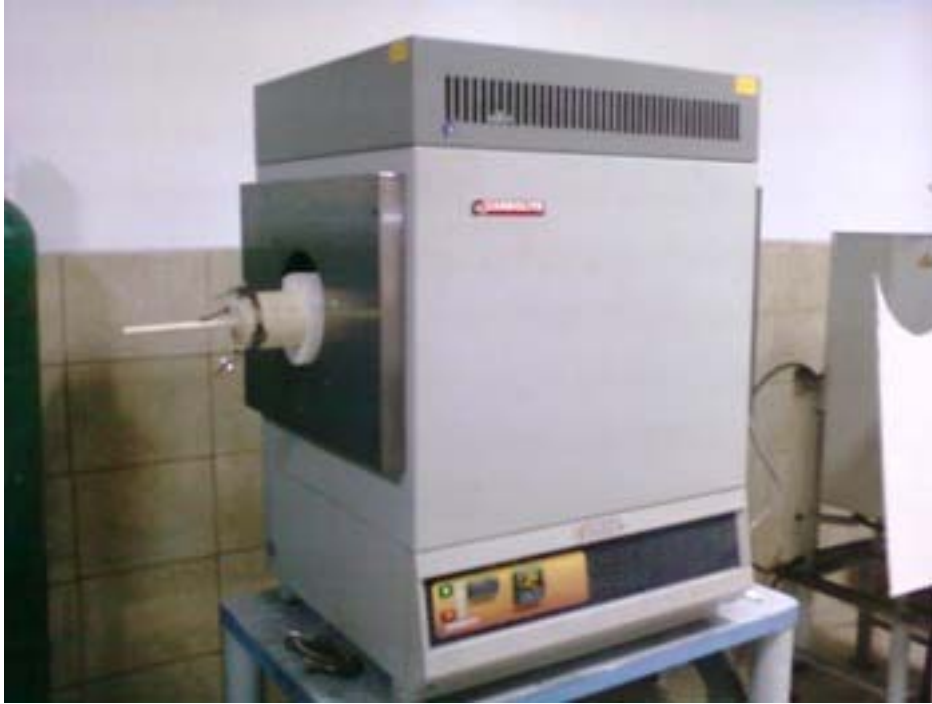
Resim 5.4. Cam yüzeyine kaplanmış titanyum dioksit ince filmlerin kristalizasyon tavlamasının yapılmış olduğu fırın
