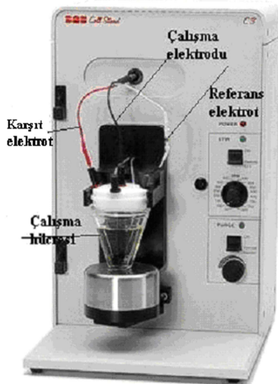
Şekil 3.1. Kaplama ve ölçümde kullanılan hücre sistemi
