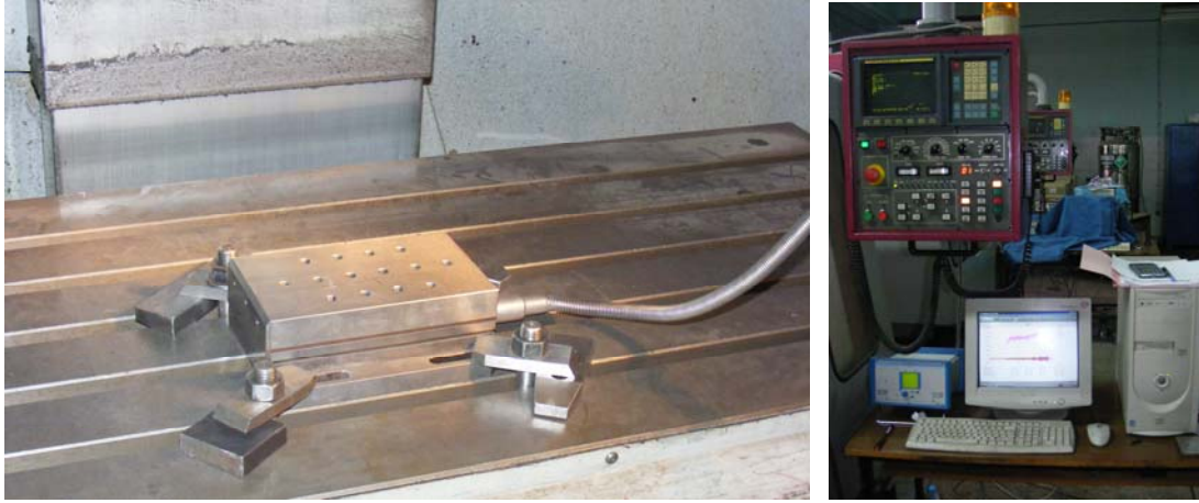
Resim 5.4. Kistler 9257B marka dinamometre
