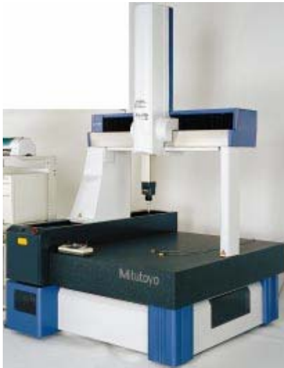
Resim 5.6. Delik çap ve daireselliklerinin ölçüldüğü CMM tezgahı
