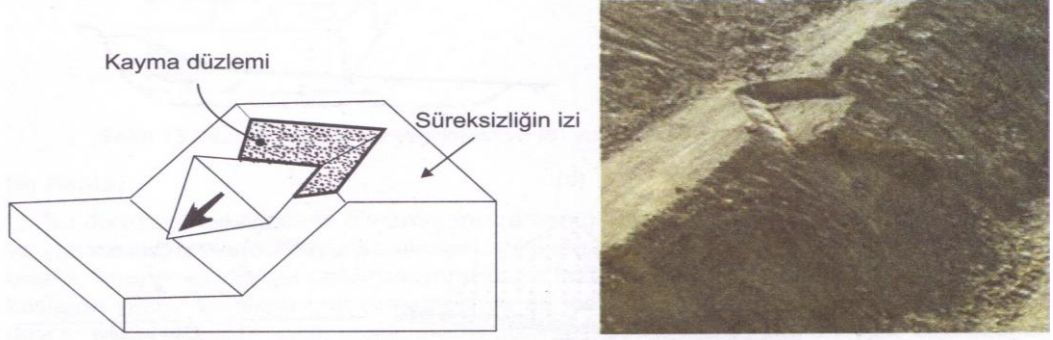
Şekil 2.9 : Kama türü kayma duyarsızlığı.
