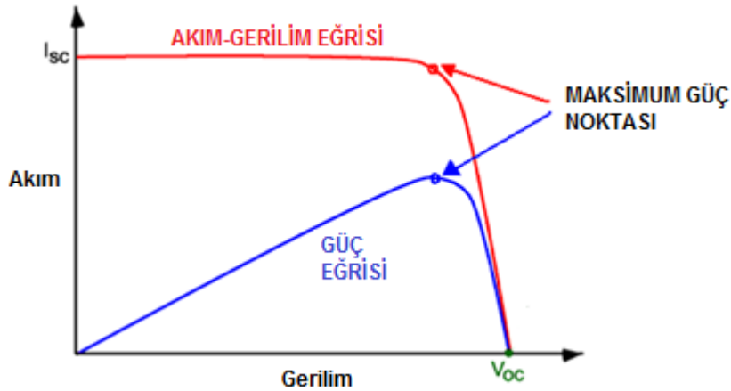
Şekil 2.2. Güneş pilinin güç karakteristiği
