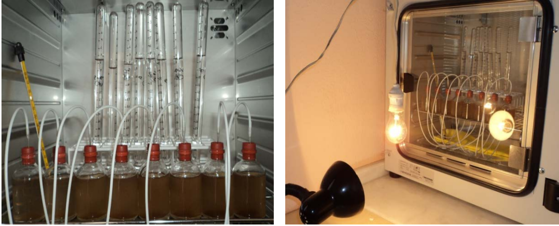
Şekil 3.11. % 9 arpa hidrolizatından hazırlanan besiyerlerinde hidrojen üretim düzeneği
