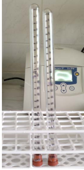
Şekil 3.8. Hidrojenin toplandığı dereceli deney tüpleri
