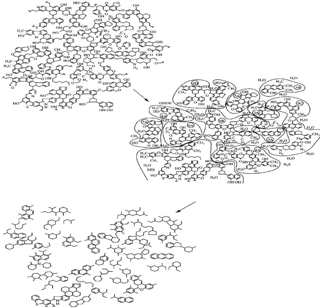
Şekil 2.7 Sıvılaştırma sırasında kömürün yapısındaki değişimler (Shinn 1984)
