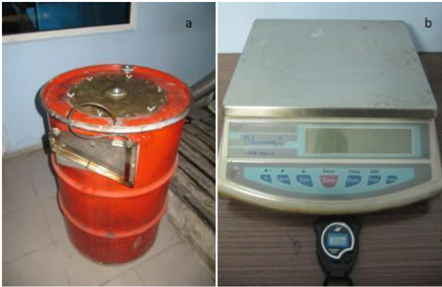
Resim 6.5. Hava ve yakıt tüketimi için kullanılan cihazlar a. Hava akışmetresi b. Elektronik terazi ve kronometre
