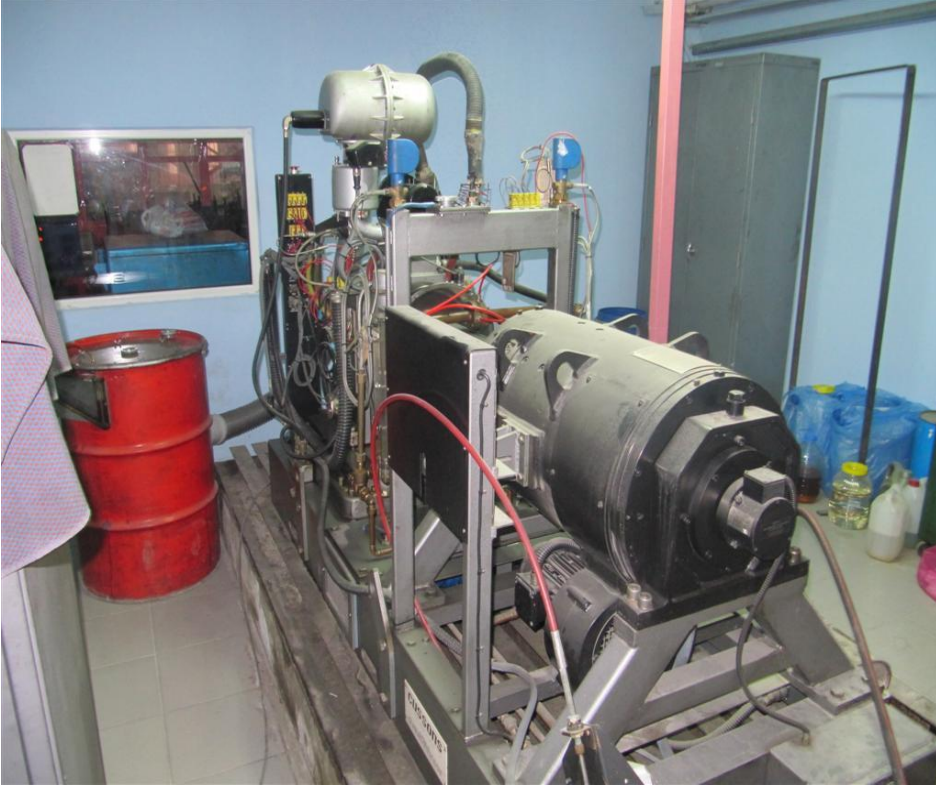
Resim 6.2. Dinamometre ve deney düzeneđi
