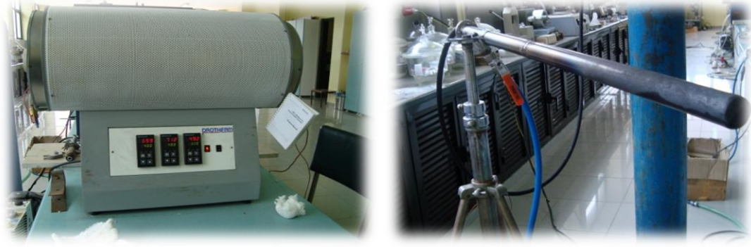
Şekil 4.4 Isıl işlemlerde kullanılan paslanmaz çelik tüp ve fırın
